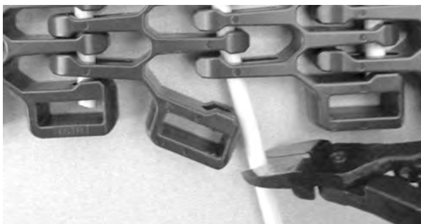
Figure 329: Ziehen des Scharnierstabes aus dem Band
