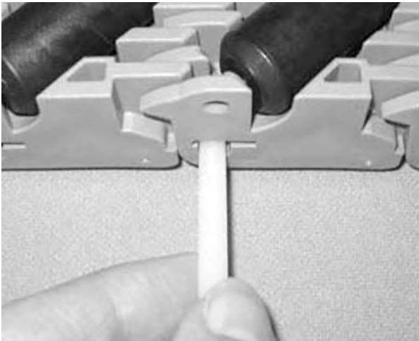
Figure 224: Führen des Scharnierstabes durch Scharniere
