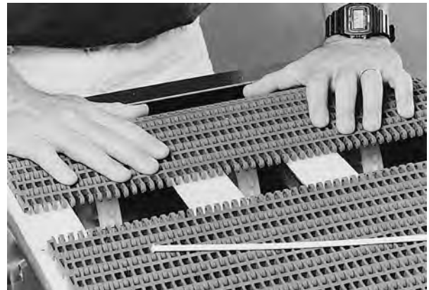
Figure 13: Zusammendrücken der Bandenden
