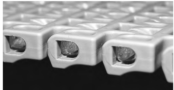
Figure 146: Scharnierstab muss Verschlussystem überragen
