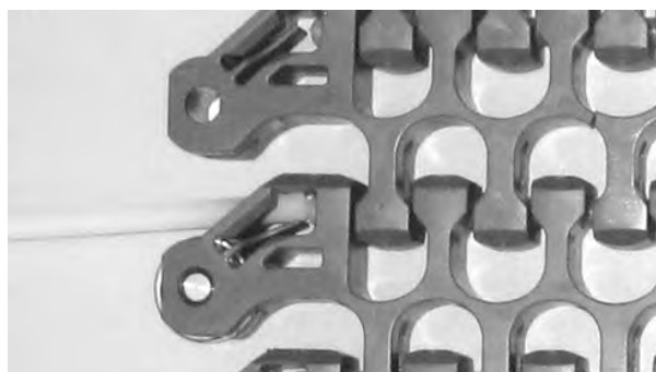
Figure 299: Ziehen des Scharnierstabes aus dem Band
