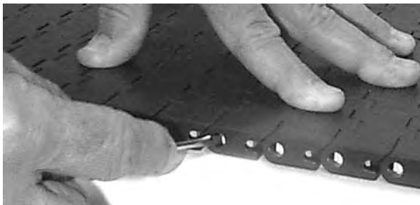
Figure 163: Öffnen des Slidelox
