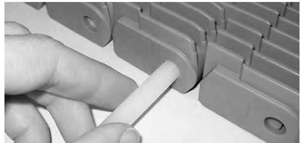
Figure 218: Ziehen des Scharnierstabes aus dem Band
