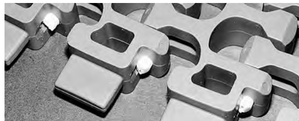
Figure 272: Scharnierstab muss vollständig eingeführt sein
