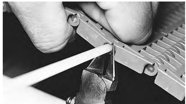
Figure 113: Abschneiden des Scharnierstabes bündig zur Bandkante
