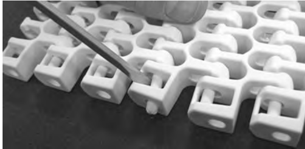
Figure 290: Vorbeischieben des Scharnierstabes am Verschlussystem
