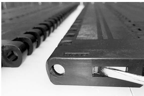
Figure 209: Schließen des Slidelox mit einem Schraubendreher
