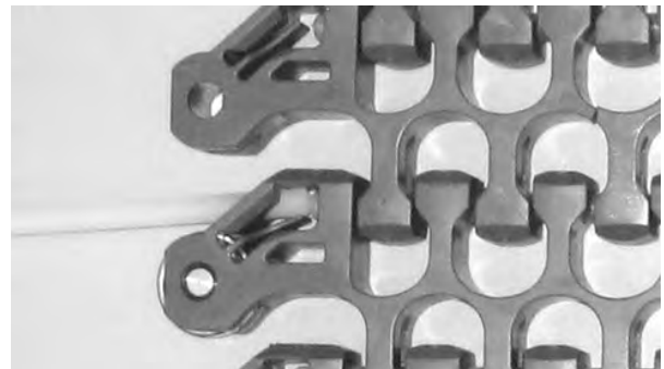
Figure 281: Abdrücken des Scharnierstabes vom Band
