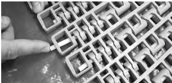
Figure 338: Scharnierstab am Verschlussystem vorbei schieben
