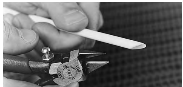
Figure 14: Gewinkeltes Einklemmen des Scharnierstabes
