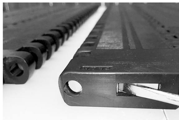
Figure 211: Schließen des Slidelox
