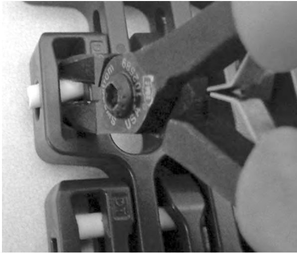
Figure 316: Beiseiteschieben des Scharnierstabes über die Bohrung hinaus
