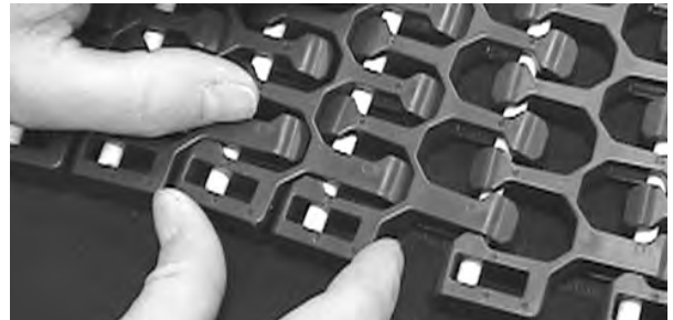
Figure 308: Scharnierstab muss vollständig eingesetzt sein
