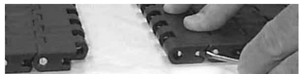
Figure 160: Schließen des Slidelox mit einem Schraubendreher
