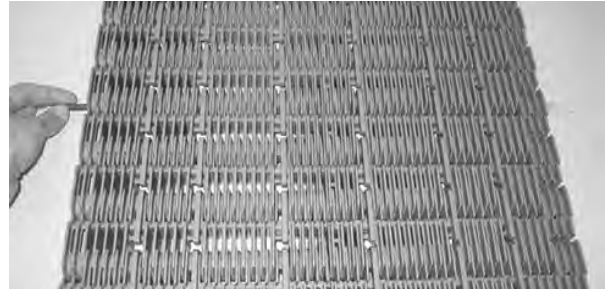
Figure 217: Öffnen des Shuttleplugs
