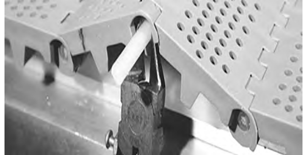
Figure 65: Abschneiden des Scharnierstabes bündig zur Bandkante
