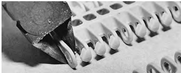
Figure 26: Ausschneiden des äußersten Glieds
