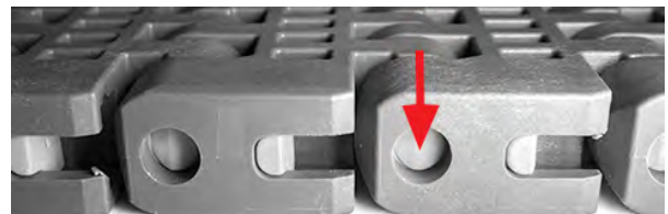
Figure 157: Öffnen des Slidelox
