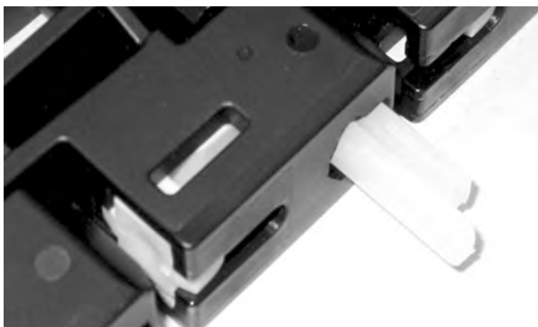
Figure 185: Führen des Scharnierstabes durch Scharniere
