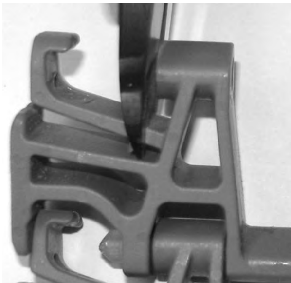
Figure 252: Abschneiden des Verschlussystems
