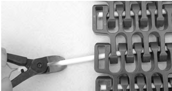
Figure 317: Ziehen des Scharnierstabes aus dem Band
