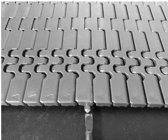
Figure 59: Scharnierstab am Verschlussssystem vorbei schieben
