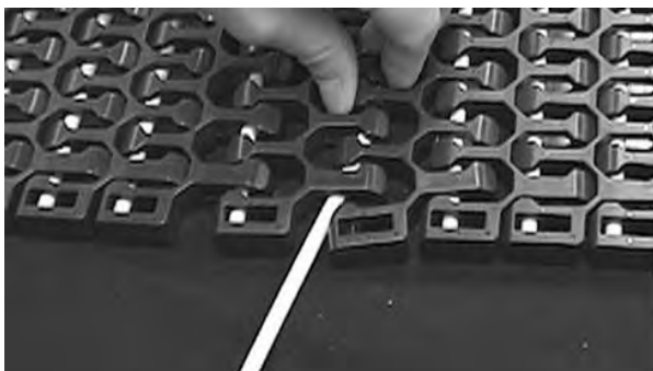
Figure 305: Ausrichten der Scharniere
