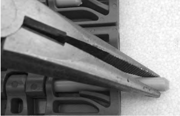
Figure 131: Ziehen des Scharnierstabes aus dem Band
