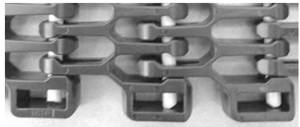
Figure 326: Scharnierstab muss vollständig eingeführt sein
