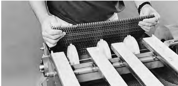
Figure 11: Verlegen des Bandes am Untertrum
