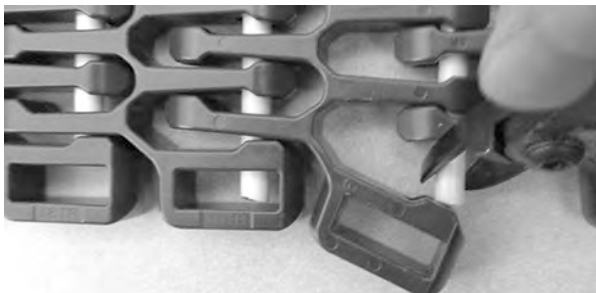
Figure 328: Ergreifen des Scharnierstabes
