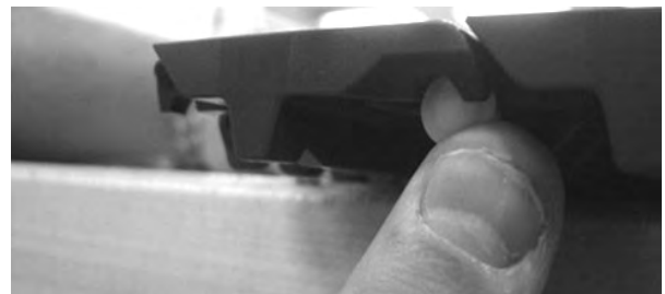
Figure 69: Scharnierstab am Verschlussystem vorbei schieben
