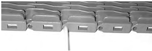
Figure 41: Einführen des Stabes
