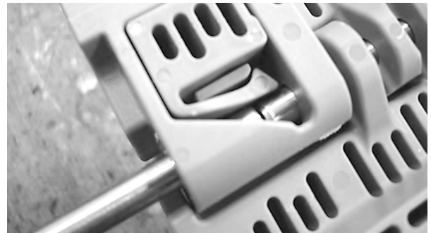
Figure 104: Scharnierstab am Verschlussystem vorbei schieben
