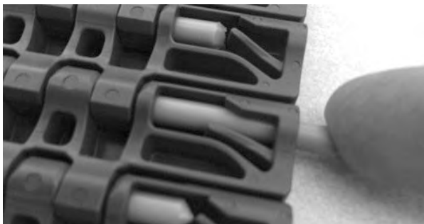
Figure 127: Einführen des Scharnierstabes durch das Scharnier
