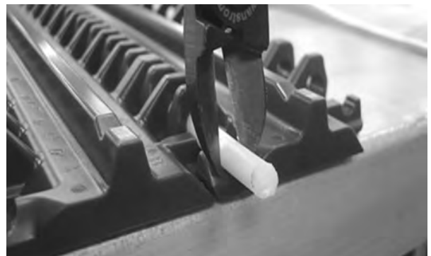
Figure 101: Ziehen des Scharnierstabes aus dem Band
