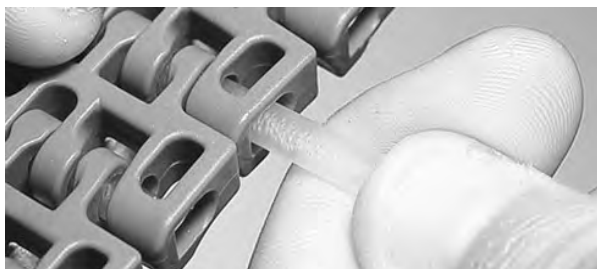
Figure 135: Führen des Scharnierstabes durch Scharniere
