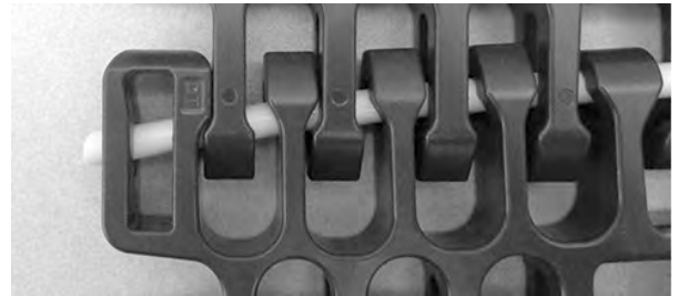
Figure 314: Scharnierstab am Verschlussystem vorbei schieben
