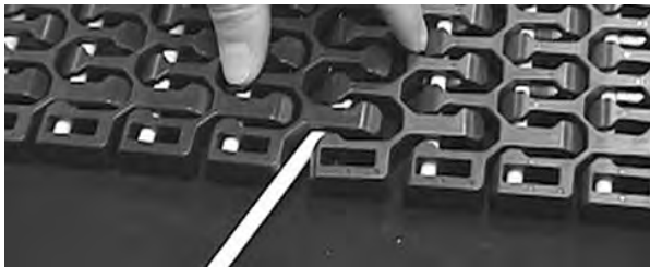
Figure 304: Führen des Scharnierstabes durch Scharniere
