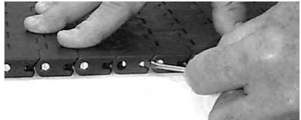
Figure 165: Schließen des Slidelox
