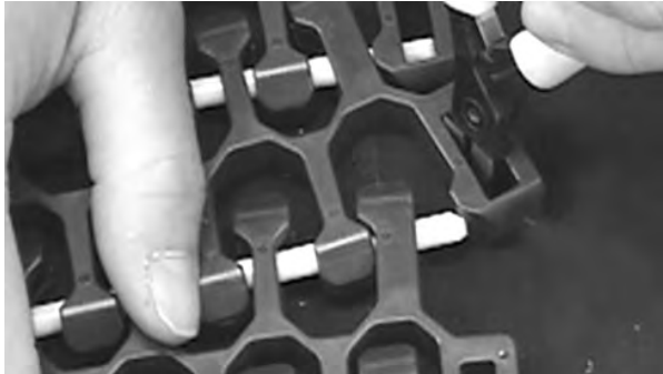
Figure 310: Biegen der bündigen Kante des Moduls zum Lösen des Scharnierstabes
