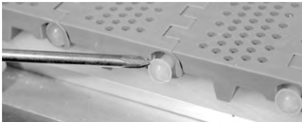
Figure 63: Eindrücken des Scharnierstabes in das Band
