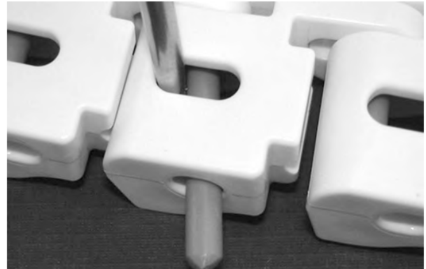
Figure 285: Vorbeischieben des Scharnierstabes am Verschlussystem
