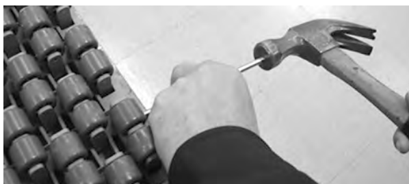
Figure 194: Abdrücken des Scharnierstabes vom Band
