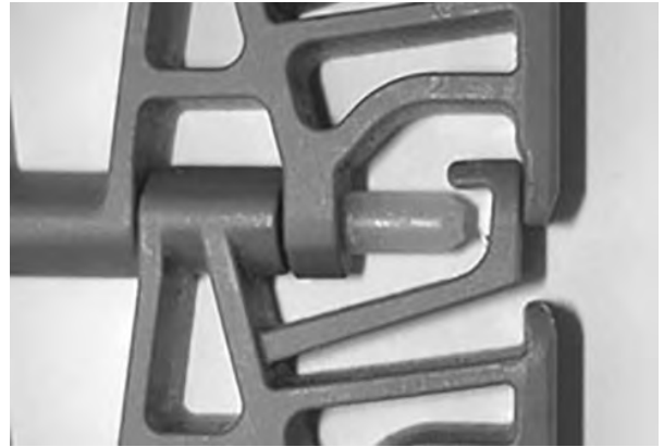
Figure 248: Scharnierstab muss Verschlussystem überragen
