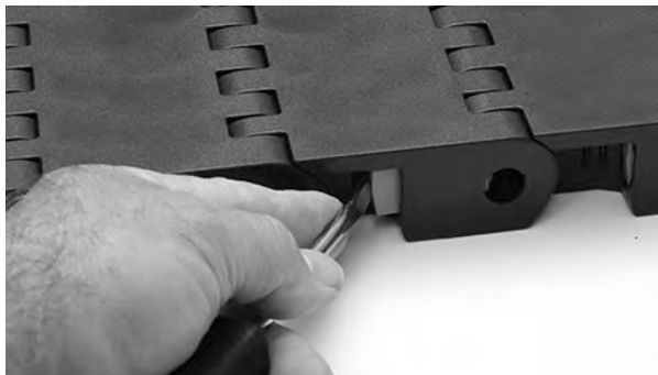
Figure 256: Schließen des Slidelox
