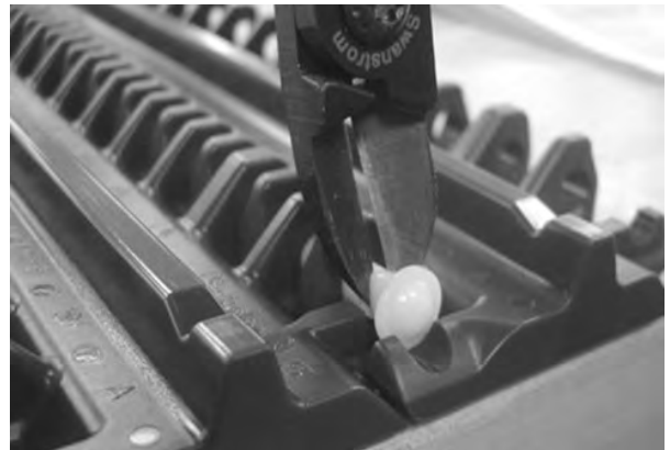
Figure 100: Abschneiden des Scharnierstabes
