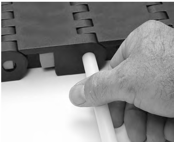
Figure 261: Einführen des Stabes
