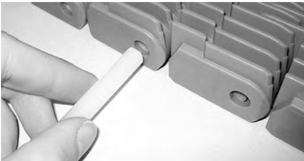
Figure 215: Führen des Scharnierstabes durch Scharniere
