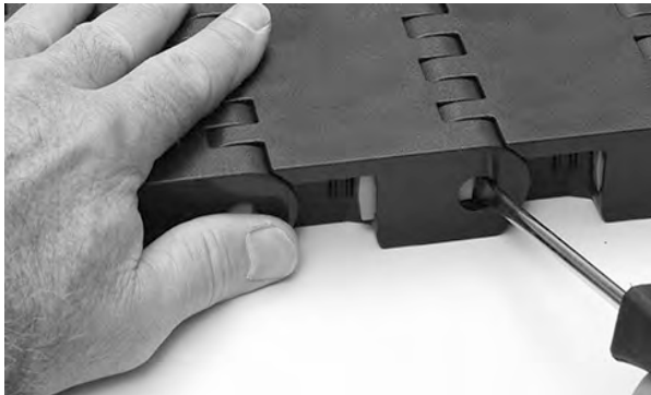
Figure 260: Öffnen des Slidelox
