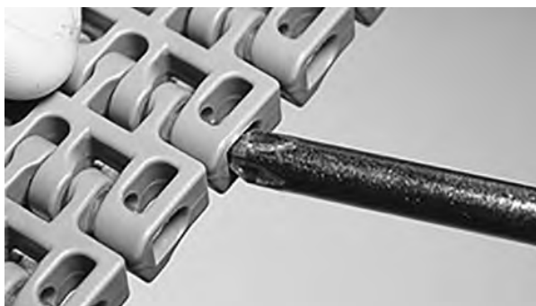
Figure 136: Scharnierstab am Verschlusssystem vorbei schieben
