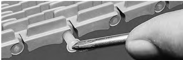
Figure 22: Eindrücken des Scharnierstabes in das Band
