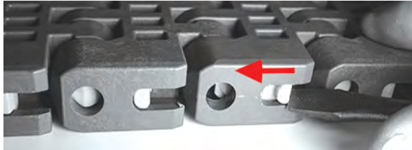
Figure 158: Schließen des Slidelox
