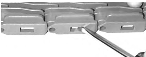
Figure 42: Schließen des Slidelox
