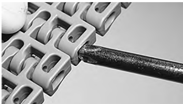
Figure 145: Scharnierstab am Verschlussystem vorbei schieben
