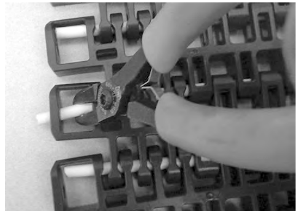
Figure 357: Scharnierstab am Verschlussystem vorbei schieben
