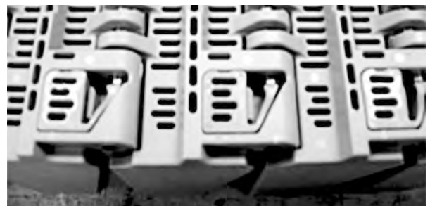
Figure 105: Verschlussystem muss geschlossen sein
