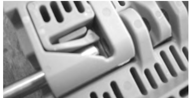
Figure 103: Führen des Scharnierstabes durch Scharniere
