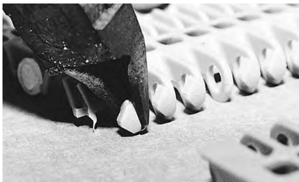
Figure 27: Abschneiden des Abstandhalters
