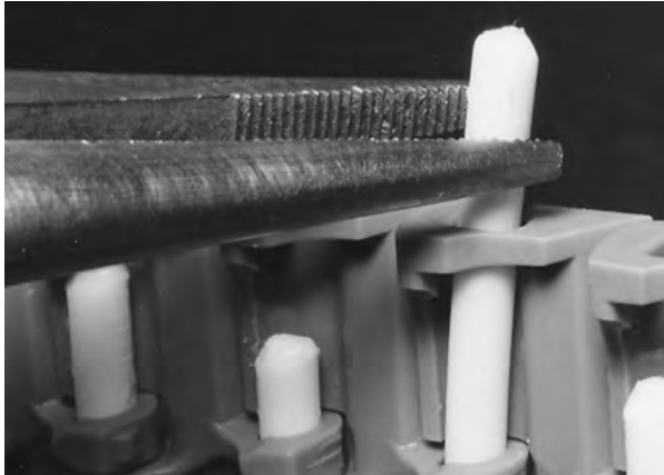
Figure 149: Ziehen des Scharnierstabes aus dem Band
