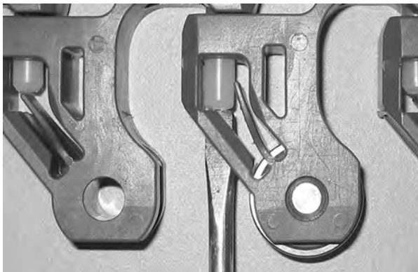
Figure 278: Scharnierstab am Verschlussystem vorbei schieben
