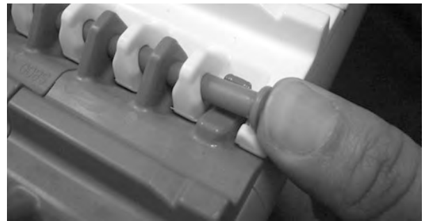
Figure 77: Scharnierstab am Verschlussystem vorbei schieben
