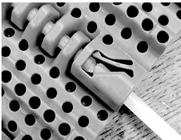
Figure 85: Scharnierstab am Verschlussystem vorbei schieben
