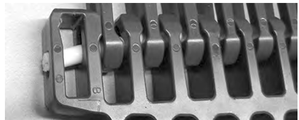
Figure 331: Führen des Scharnierstabes durch Scharniere
