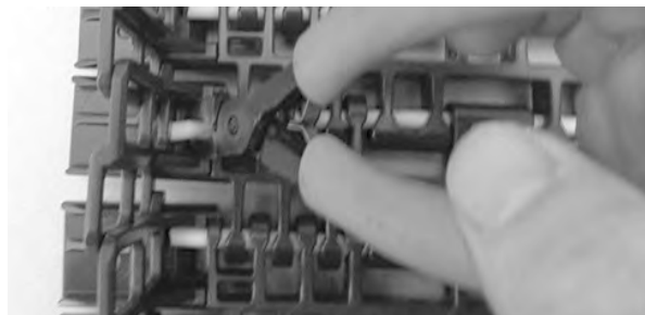
Figure 353: Ziehen des Scharnierstabes aus dem Band
