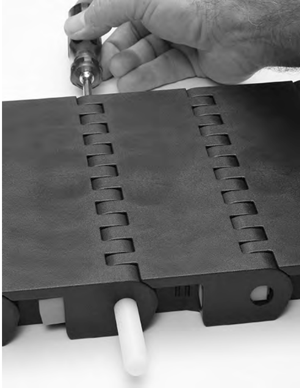
Figure 259: Abdrücken des Scharnierstabes vom Band
