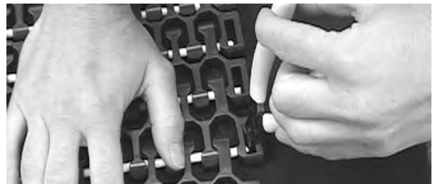
Figure 309: Eindrücken des Scharnierstabes in das Band
