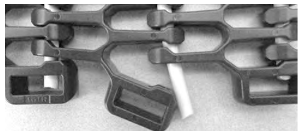
Figure 325: Hinausschieben des Scharnierstabes über die Bandkante
