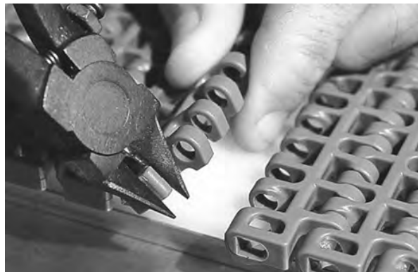
Figure 142: Abschneiden der Kante vom Band
