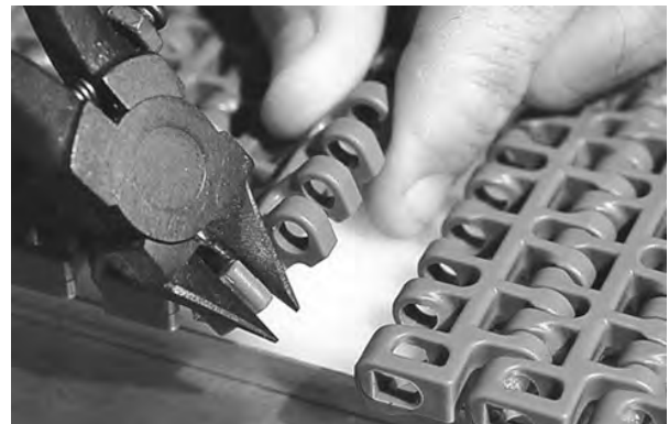
Figure 152: Abschneiden der Kante vom Band
