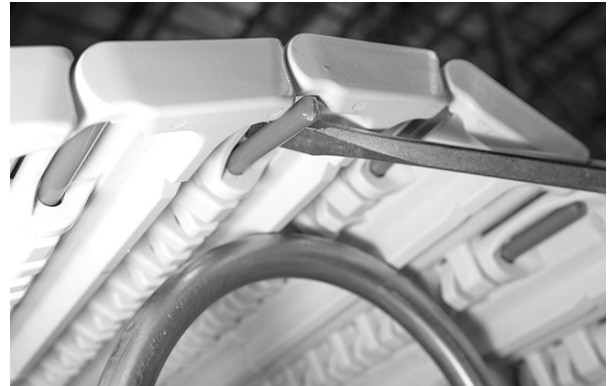
Figure 90: Verdrehen des Schraubendrehers
