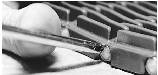
Figure 112: Scharnierstab muss Schnappverschluss überragen
