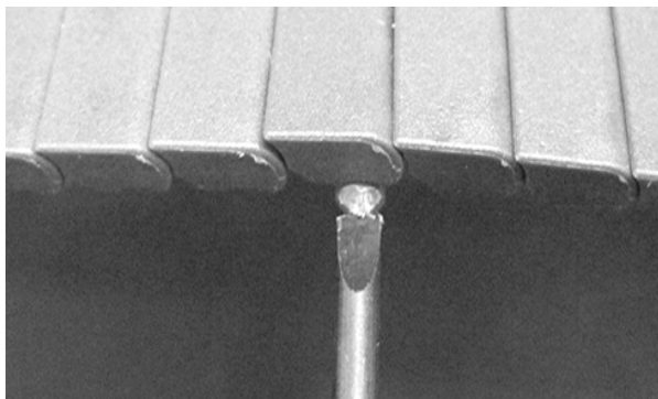
Figure 54: Vorbeischieben des Scharnierstabes am Verschlussystem
