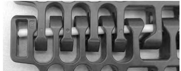
Figure 315: Scharnierstab muss Verschlussystem überragen
