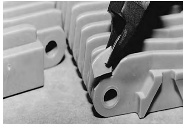
Figure 47: Abschneiden der äußersten Rippe
