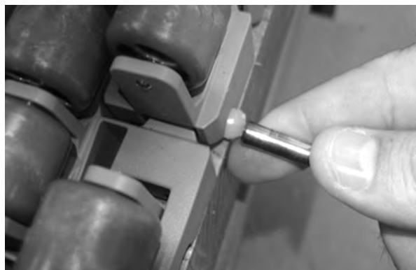
Figure 190: Scharnierstab am Verschlussystem vorbei schieben
