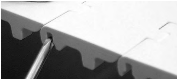
Figure 204: Vorbeischieben des Scharnierstabes am Verschlussystem
