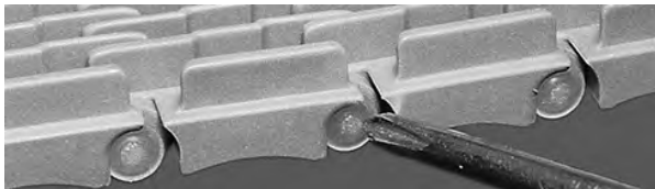
Figure 23: Kopf des Scharnierstabes muss Schnappverschluss überragen
