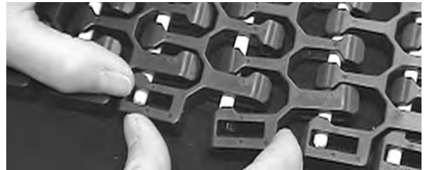
Figure 307: Einschieben des Scharnierstabes über die Bandkante hinaus, Einrasten der bündigen Kante über dem Scharnierstab
