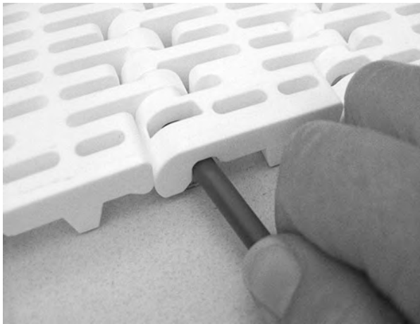
Figure 79: Eindrücken des Scharnierstabes in das Band
