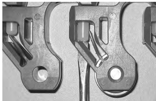
Figure 300: Scharnierstab am Verschlussystem vorbei schieben
