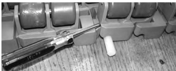
Figure 195: Ziehen des Scharnierstabes aus dem Band
