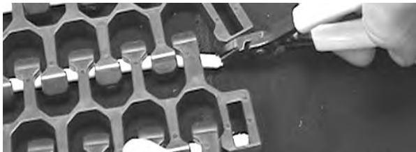
Figure 311: Ergreifen des Scharnierstabes
