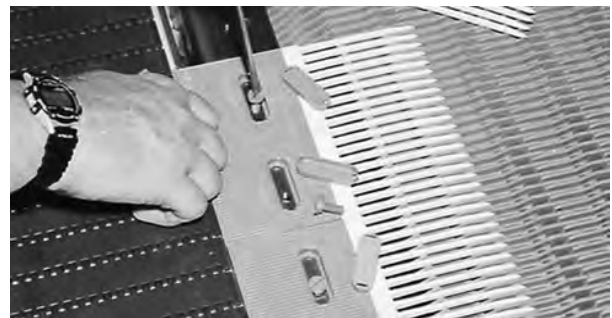
Figure 18: Montage der Fingerübergabeplatten mit Intralox-Kunststoffschrauben
