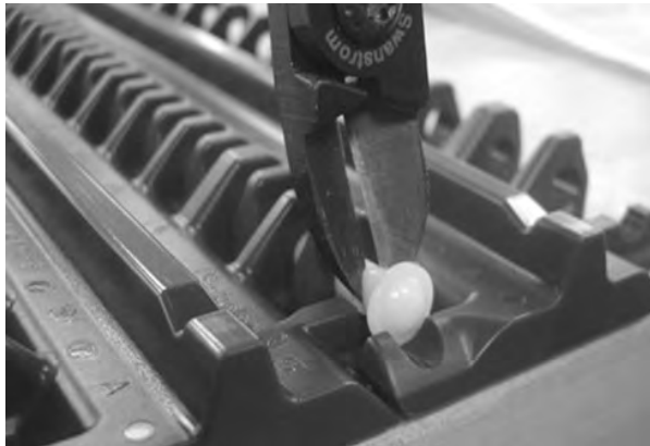
Figure 71: Abschneiden des Scharnierstabes
