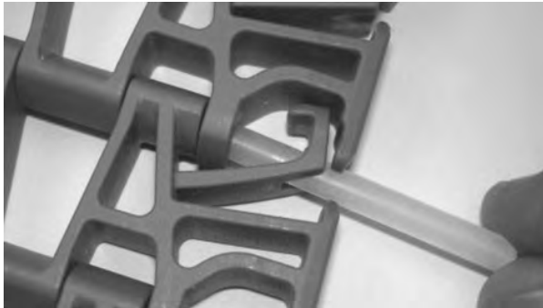
Figure 246: Führen des Scharnierstabes durch Scharniere
