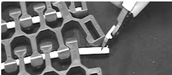
Figure 312: Ziehen des Scharnierstabes aus dem Band
