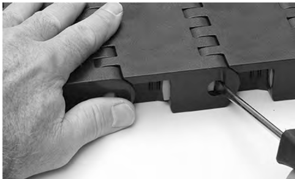
Figure 257: Öffnen des Slidelox
