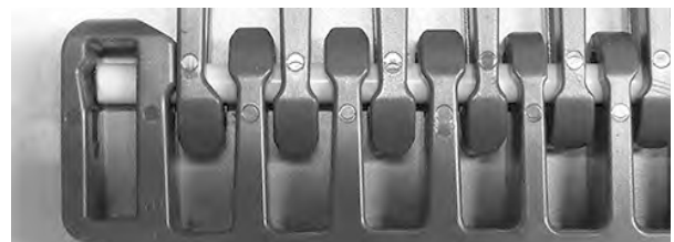
Figure 332: Scharnierstab muss Verschlussystem überragen
