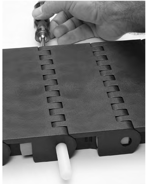
Figure 263: Abdrücken des Scharnierstabes vom Band
