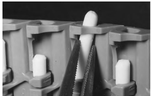
Figure 148: Scharnierstab am Verschlussystem vorbei schieben
