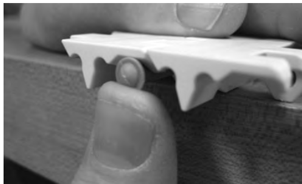
Figure 179: Eindrücken des Scharnierstabes mit dem Daumen
