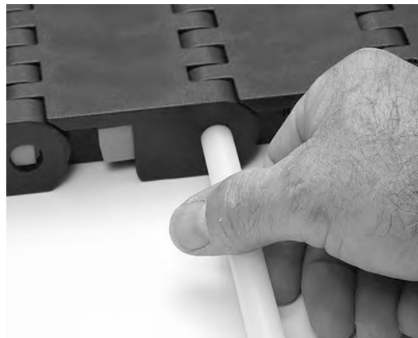
Figure 258: Einführen des Stabes
