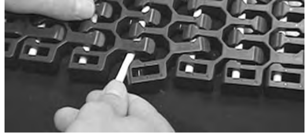
Figure 306: Führen des Scharnierstabes durch Scharniere
