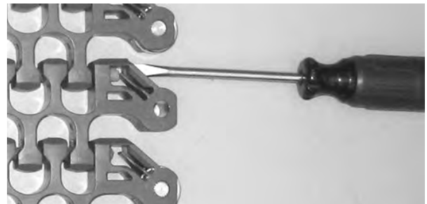
Figure 280: Öffnen des Verschlussystems
