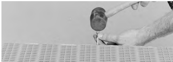
Figure 32: Abdrücken des Scharnierstabes vom Band
