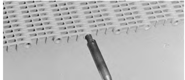
Figure 30: Verschließen der Scharnierstaböffnung
