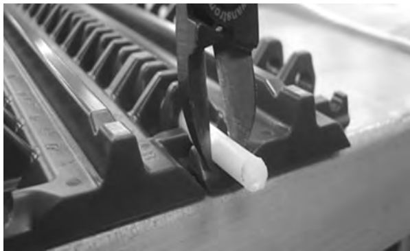
Figure 72: Ziehen des Scharnierstabes aus dem Band
