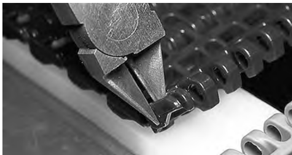
Figure 140: Abschneiden der Hälfte der Kante
