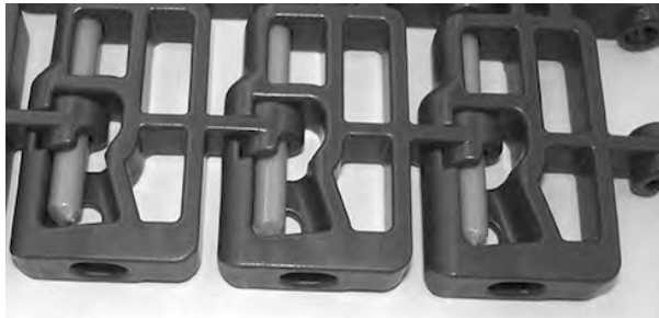
Figure 117: Stange geht in bündige Kante über
