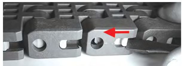
Figure 156: Schließen des Slidelox
