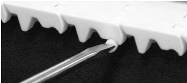
Figure 174: Scharnierstab am Verschlussystem vorbei schieben
