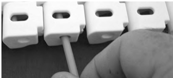
Figure 282: Führen des Scharnierstabes durch Scharniere
