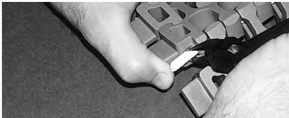
Figure 274: Ergreifen des Scharnierstabes
