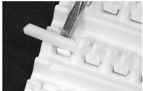
Figure 176: Heben des Scharnierstabes über das Verschlussystem
