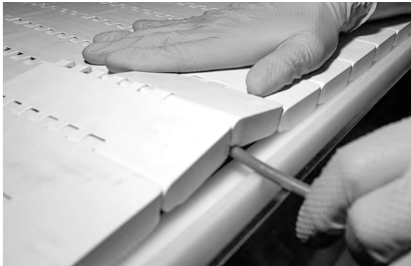
Figure 88: Leichtes Biegen und Einführen des Scharnierstabes durch die Scharniere
