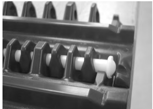
Figure 70: Scharnierstab muss Verschlussystem überragen
