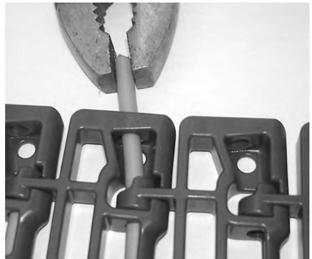
Figure 126: Ziehen des Scharnierstabes aus dem Band
