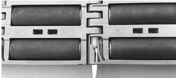
Figure 241: Scharnierstab am Verschlussystem vorbei schieben
