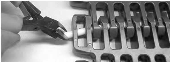
Figure 334: Ziehen des Scharnierstabes aus dem Band
