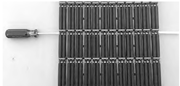
Figure 243: Abdrücken des Scharnierstabes vom Band
