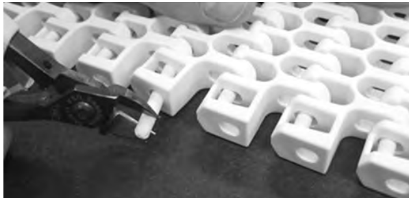
Figure 291: Ziehen des Scharnierstabes aus dem Band
