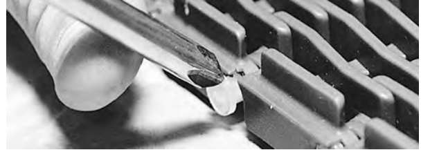
Figure 111: Eindrücken des Scharnierstabes in das Band
