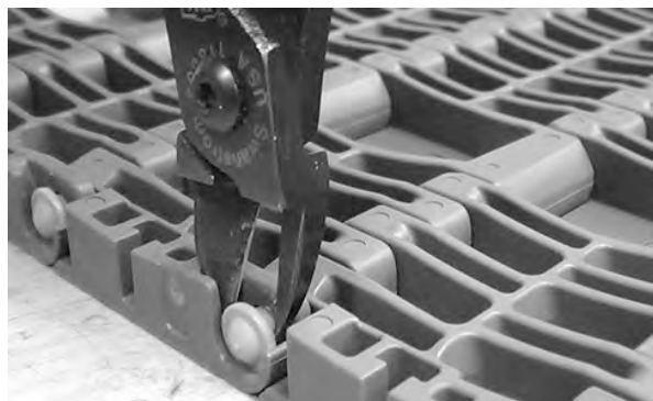
Figure 268: Ausschneiden des Rodlets
