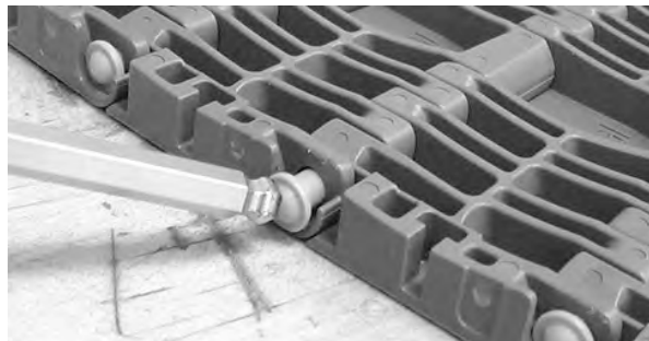
Figure 267: Vorbeischieben des Rodlets am Verschlussystem
