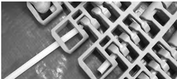
Figure 337: Führen des Scharnierstabes durch Scharniere
