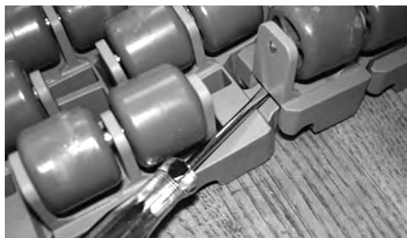
Figure 192: Einsetzen des Schraubendrehers unter der Rolle
