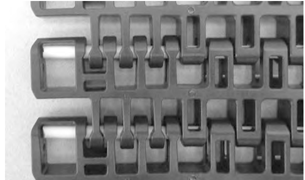
Figure 356: Scharnierstab muss Verschlussystem überragen
