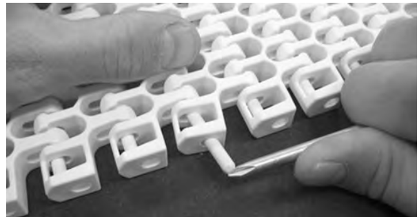
Figure 288: Scharnierstab am Verschlusssystem vorbei schieben
