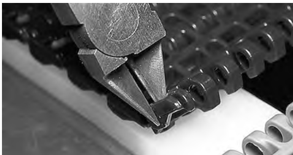
Figure 150: Abschneiden des Kantenglieds
