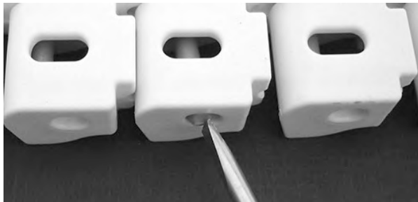
Figure 283: Scharnierstab am Verschlussystem vorbei schieben
