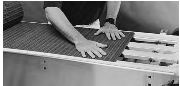
Figure 8: Verlegung des Bandes am Antriebsende
