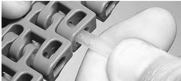
Figure 144: Führen des Scharnierstabes durch Scharniere
