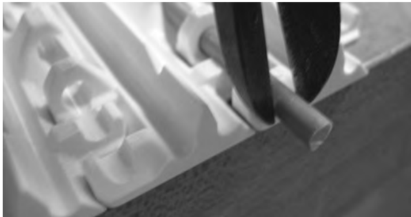
Figure 183: Ziehen des Scharnierstabes aus dem Band
