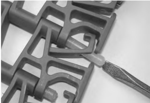
Figure 247: Scharnierstab am Verschlussystem vorbei schieben
