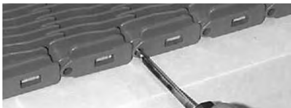
Figure 44: Abdrücken des Scharnierstabes vom Band
