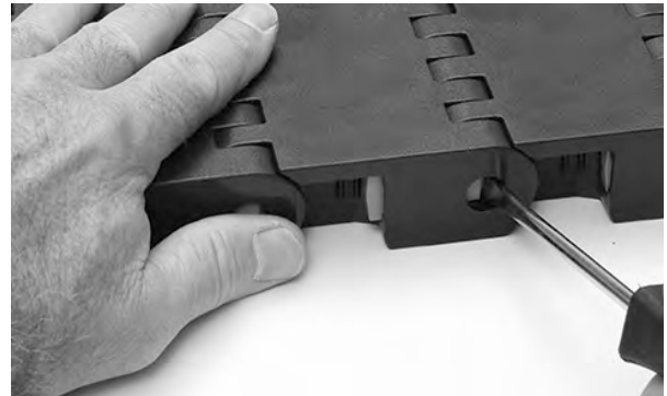
Figure 262: Öffnen des Slidelox
