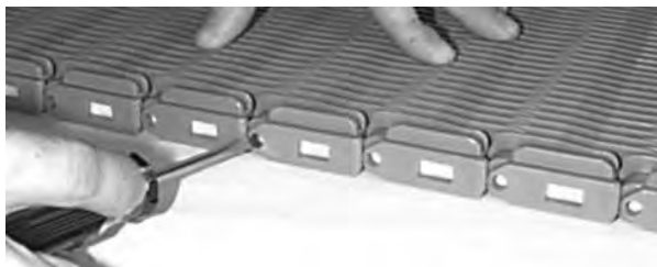
Figure 43: Öffnen des Slidelox
