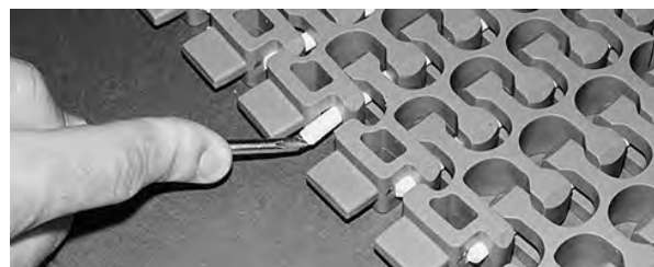
Figure 271: Scharnierstab muss Verschlussystem überragen
