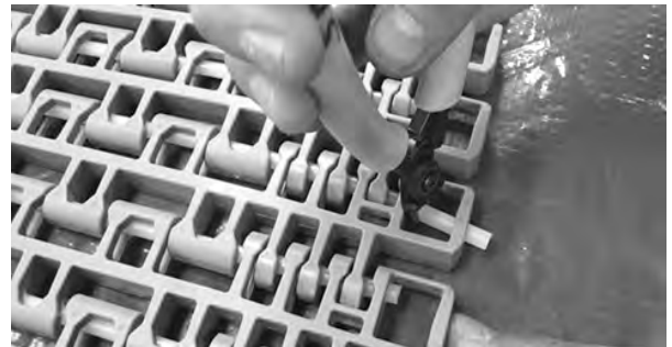
Figure 340: Ziehen des Scharnierstabes aus dem Band
