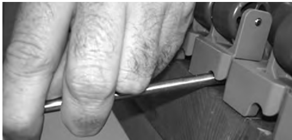
Figure 193: Einführen des Stahl-Verbindungsstifts in das Scharnier
