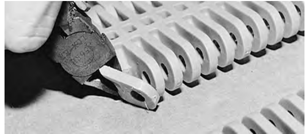
Figure 46: Ausschneiden des äußersten Glieds
