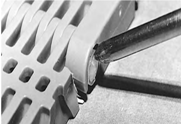
Figure 48: Vorbeischieben des Scharnierstabes am Verschlussystem
