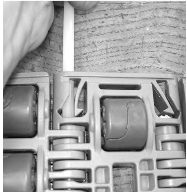
Figure 221: Abdrücken des Scharnierstabes vom Band
