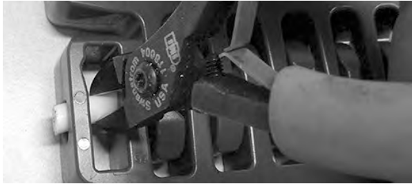
Figure 333: Beiseiteschieben des Scharnierstabes über die verdeckte Bohrung hinaus
