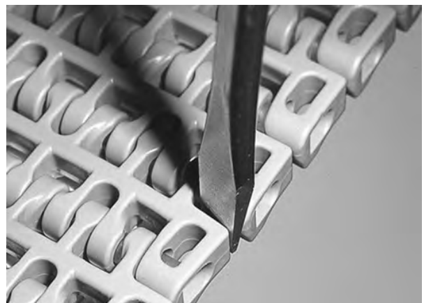
Figure 138: Scharnierstab am Verschlusssystem vorbei schieben
