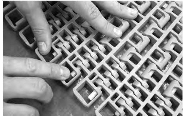
Figure 339: Scharnierstab muss Verschlussystem überragen
