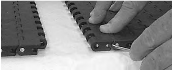
Figure 162: Schließen des Slidelox
