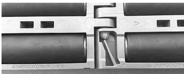
Figure 242: Scharnierstab muss Verschlussystem überragen
