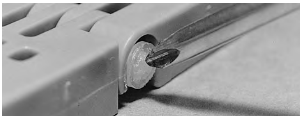
Figure 38: Kopf des Scharnierstabes muss Schnappverschluss überragen
